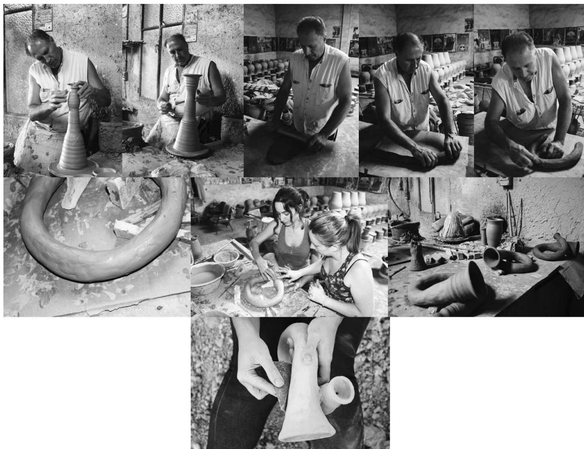
Figura 5. Técnicas empleadas en la manufactura experimental de las Trompas Numantinas: Amasado, modelado a torno, fabricación de los tubos, ensamblado, secado y lijado. Foto: Autor.
